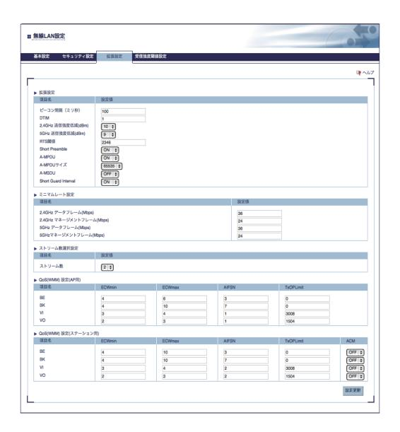
拡張設定画面では無線 LAN 機能の「拡張設定」、「ミニマムレート」、「ストリーム数」、「QoS(WMM) 設定 AP 用」および「Q0S/(WMM) 設定(ステーション用)」の設定・変更をおこないます。
