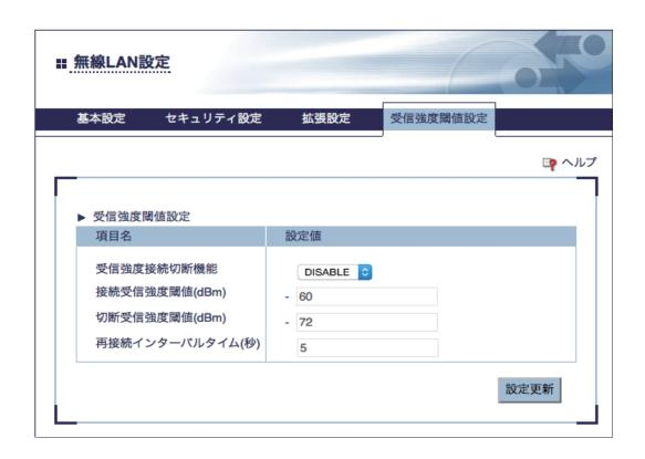
本機能を有効にするには「受信強度接続切断機能」を「ENABLE」にします。
