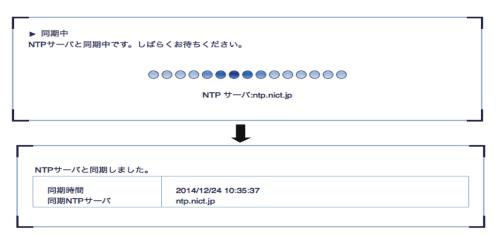
※ NTP サーバーアドレスを URL で設定する場合は、「機器」設定で必ず DNS サーバーアドレスを設定してください。
