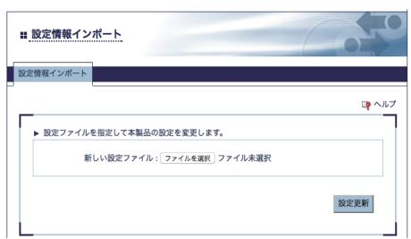
設定情報インポート画面が表示されます。「参照」をクリックします。 設定情報ファイル(config.txt)の保存先を確認するメッセージが表示されます。 「保存」をクリックします。
