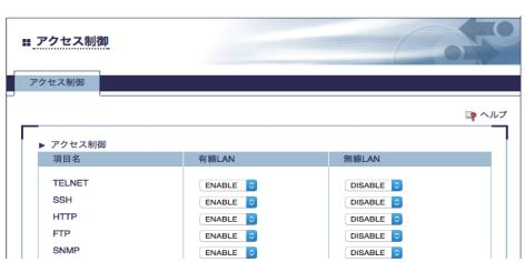
設定を「DISABLE」にすると、本製品はアクセスを拒否します。TELNET、SSH、HTTP を「ENABLE」にすることにより、それぞれのプロトコルで本製品に接続し、設定の変更等をおこなうことができます。それ以外に下記プロトコルが利用できます。
