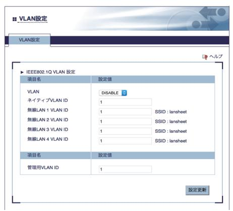
本装置は Multi SSID に対応していますので、最大で 4 つの仮想的なネットワークグループが構成できます。
