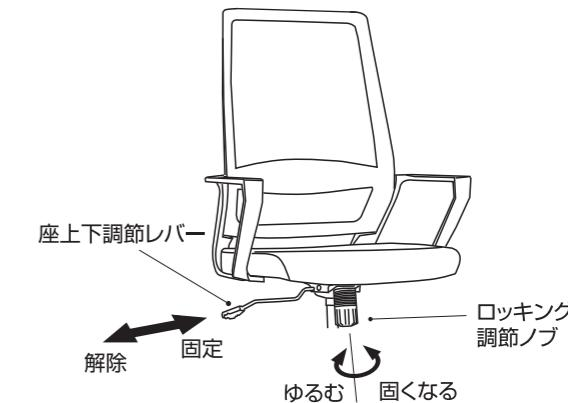
座の裏のロッキング調節ノブを回してロッキング固さを調節してください。座面右下の座上下調節レバーを座面中央に向かって押し込むと、ロッキングが固定されます。手前に引くとロッキングが解除されます。ロッキング固定は初期角度のみ可能です。
