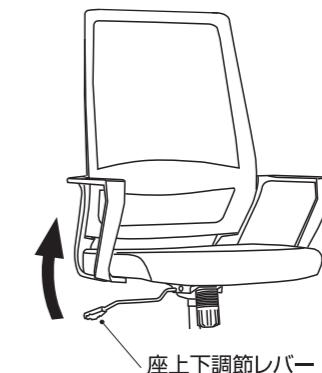
座面中央に腰掛け、座面右下の座上下調節レバーを上方向に持ち上げながら、座面へ体重をかけたり、腰を浮かせたりすると座面が上下に動きます。任意の位置でレバーを離すと座面が固定されます。
