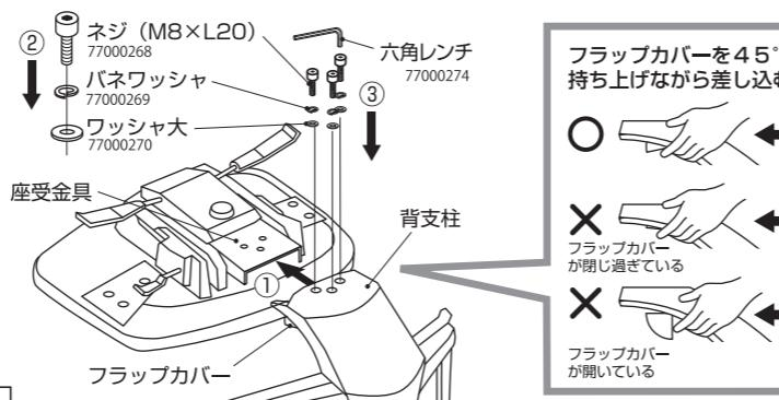
**警告** ネジは最後までしっかりと締め込んでください。ゆるんだまま使うとネジが折れるなど破損の可能性があり、けがをすることがあります。
