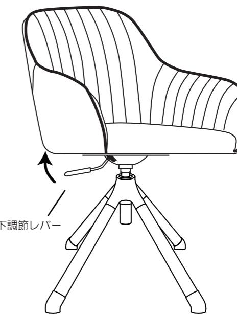
座面中央に腰掛け、座面右下の座面上下調節レバーを上下方向に持ち上げながら、座面へ体重をかけたり、腰を浮かせたりすると座面が上下に動きます。
