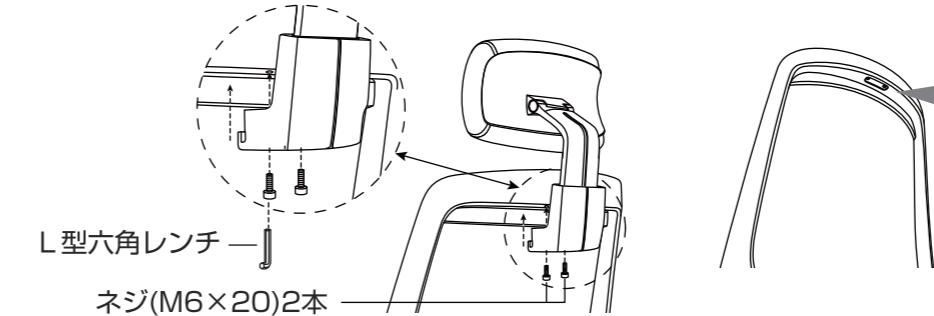
ネジが上手く入らない場合は、背もたれの中に入っているメネジがずれている可能性があります。その際は、ネジ穴に細めのドライバーなどを差し込んでメネジの位置を中心に調整してください。
