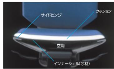
荷重に応じてたわみ、体にフィットするフロート・ベンディングシート。シートの下は空洞なので、熱がこもりにくく快適さもアップしている(トリノチェア)
