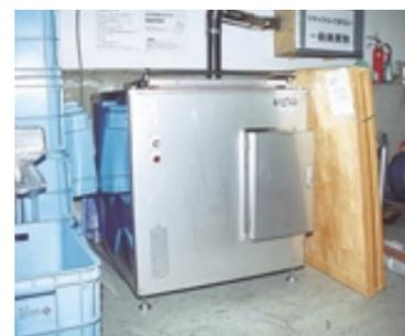
生ゴミ処理機で有機肥料に分解された生ゴミは事業所の植栽の肥料として使用
