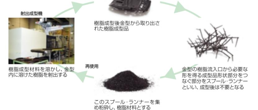
樹脂成型材料を溶かし、金型内に溶けた樹脂を射出する
