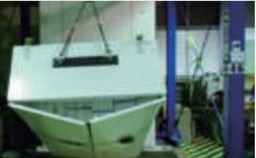
振動試験での製品転倒検証
