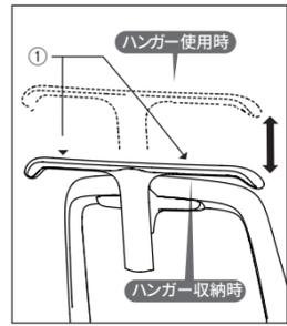
ハンガー本体(矢印①)を両手でしっかりと握り、上方に「カチッ」と音がするまで引き上げてください。60mmの上下調節ができます。収納時はハンガー本体(矢印①)を両手でしっかりと握り、下方に「カチッ」と音がするまで押し下げてください。
