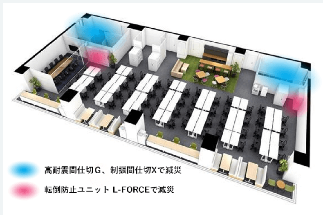
減災建材とキャビネット単独の転倒防止策による減災空間の提案例
