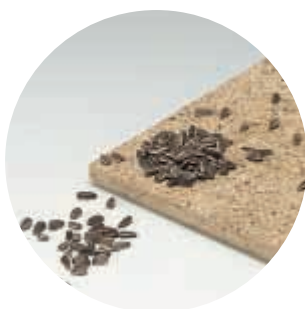
ダコタパール ひまわりの種を粉碎し、 熱圧成型したボード
