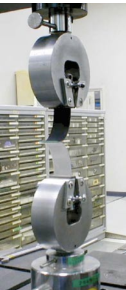
引っ張り強度試験
