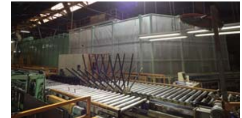
スチール棚製造部(京都)の塗装ライン(バーナーの燃料を、従来の灯油からLPガスへ転換)
