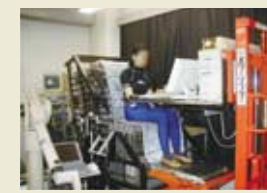
研究に使われた実験イス。好みの寸法・角度・クッション硬さなどが計測できる。
